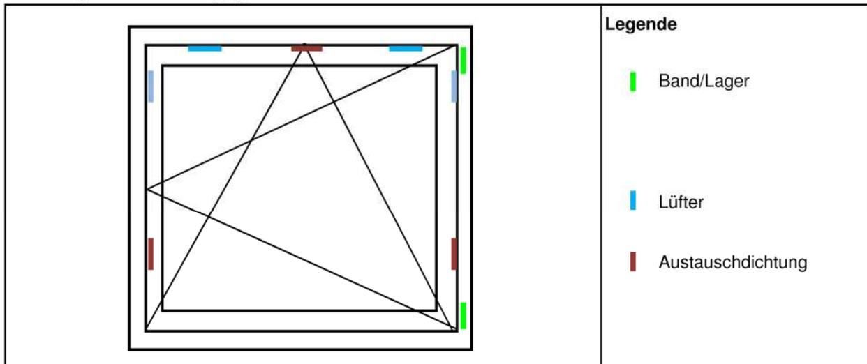
Die Prüfung nach DIN EN 13141-1 6.3 wurde bei der höchsten Druckstufe (150 Pa) bestanden.
