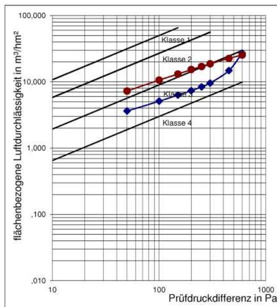
**Diagramm:** Flächenbezogene Luftdurchlässigkeit (Winddruck und Windsog)
