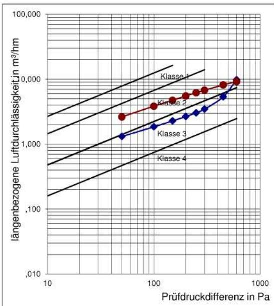
**Diagramm:** Längenbezogene Luftdurchlässigkeit (Winddruck und Windsog)
