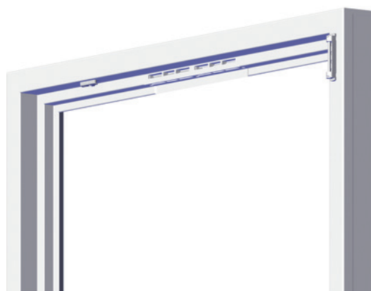
Kłapy zamknięte (przy zbyt wysokim ciśnieniu wiatru)
