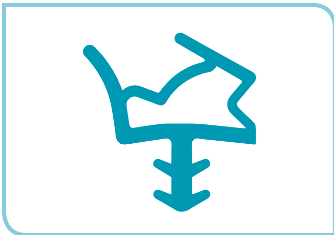
Querschnitt einer originalen Türdichtung (Quelle: Deventer)
